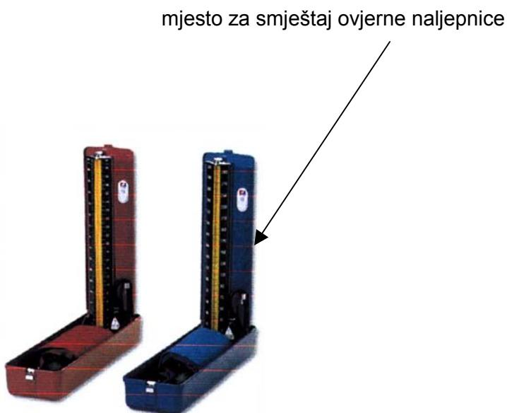
Slika 1: Fotografija tlakomjera za krvni tlak tip TL-10 s prikazom mesta za smještaj ovjerne naljepnice
